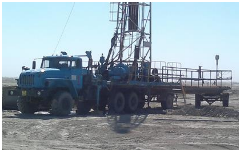
Сурет 3.6 – Бұрғылау қарнағына арналған, тіркемесі бар 15 В өздігінен жүретін бұрғылау агрегаты
