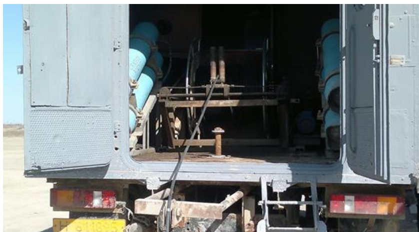
Сурет 3.5 – Технологиялық түрлендірілген ұңғыма пневматикалық аппараты
